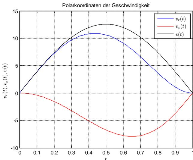
Damit sind alle Ableitungen bis zur ersten Ordnung vollständig beschrieben. Im Gegensatz zur Bahngeschwindigkeit sind die Komponentengeschwindigkeiten nicht symmetrisch zur Halbperiode. Die Komponentengleichungen der Beschleunigung sind in kartesischen Koordinaten gegeben durch
