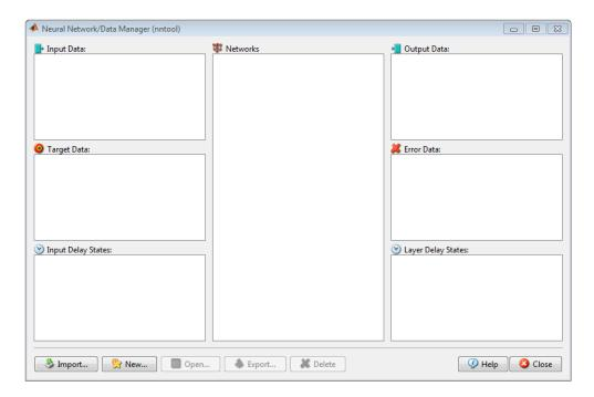
Klicken Sie auf **New** und es erscheint das Fenster Create Network or Data. Wechseln Sie zu **Data**, setzen Sie **Name** auf p, **Value** auf [0 0 1 1;0 1 0 1] und stellen Sie sicher, daß **Data Type** auf **Inputs** steht. Danach drücken Sie **Create**, um das Input file p zu generieren. Der Create Network or Data Manager erscheint und zeigt p als Eingabe.
