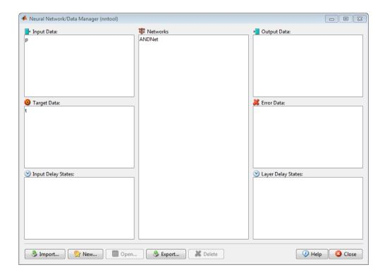
Um das Netzwerk zu trainieren, markieren Sie die Zeile, in der ANDNet steht, und klicken danach auf **Open**. Wählen Sie den Reiter **Train** und geben Sie unter **Inputs** p und unter **Targets** t ein.
