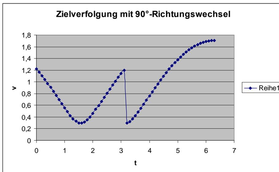
Abbildung 6. Bei Richtungswechsel erfährt die Bahngeschwindigkeit einen Sprung
