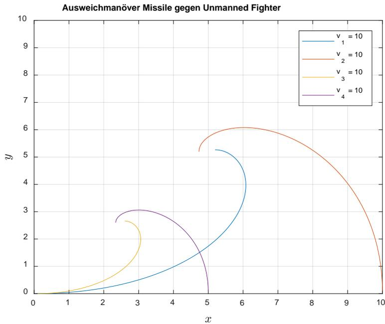
Abbildung 4. Angreifender Flugkörper fliegt genauso schnell wie unbemannter Fighter
