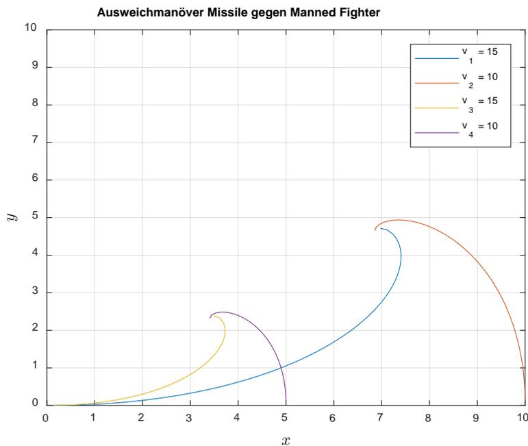
Abbildung 3. Angreifender Flugkörper fliegt eineinhalbmal so schnell wie bemannter Fighter
