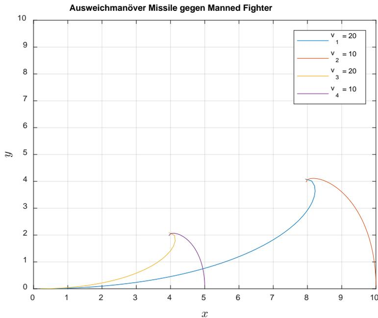
Abbildung 2. Angreifender Flugkörper fliegt doppelt so schnell wie bemannter Fighter
