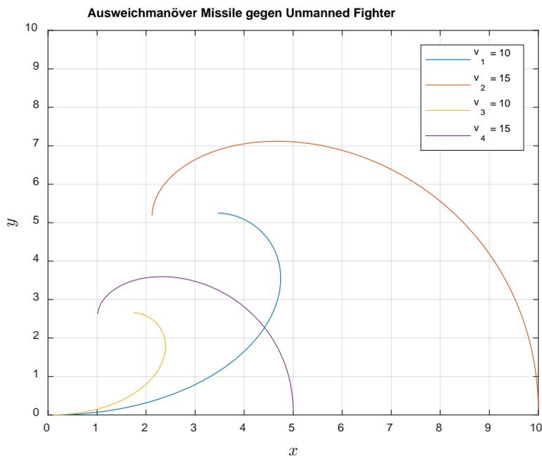
Abbildung 5. Unbemannter Fighter fliegt eineinhalbmal so schnell wie angreifender Flugkörper
